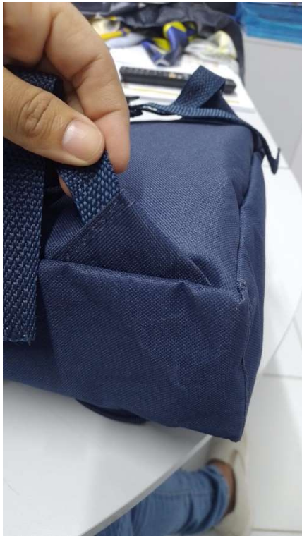
Detalhe para reforço em triângulo
